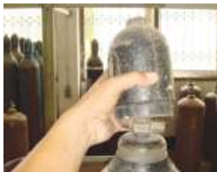
ภาพที่ 3.40 แสดงการถอดฝาครอบหัวท่อ ภาพที่ 3.39 แสดงการนำเปิดวาล์วหัวท่อออกซิเจน
