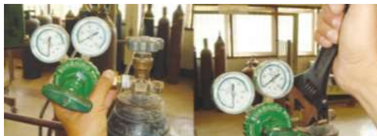
ภาพที่ 3.42 แสดงการประกอบมาตรวัดความดันกับท่อออกซิเจน
