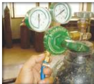
ภาพที่ 3.44 แสดงการต่อท่อสายยางเข้ากับมาตรวัดความดันแก๊สออกซิเจน
