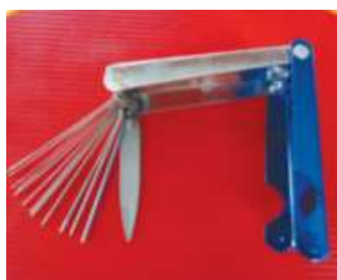
ภาพที่ 3.29 แสดงชุดทำความสะอาดหัวทิฟและการทำความสะอาดหัวทิฟ
