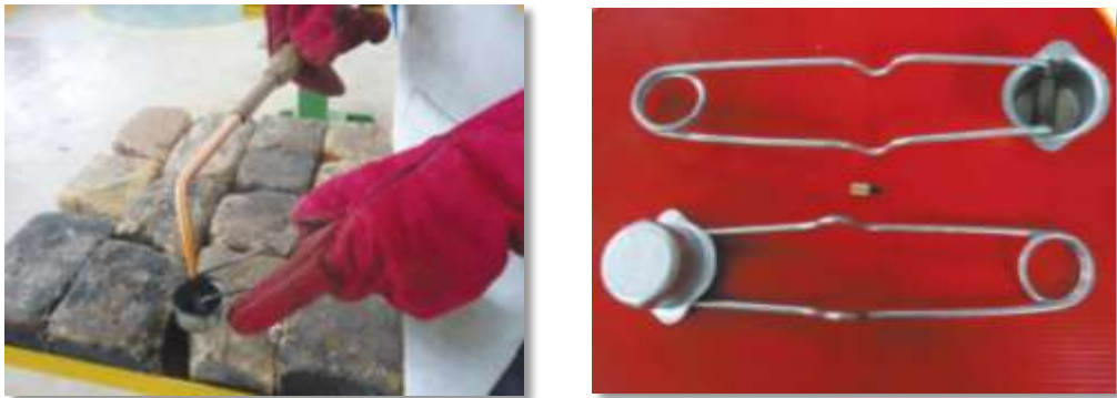
ภาพที่ 3.33 แสดงการจุดเปลวไฟด้วยอุปกรณ์จุดเปลวไฟ
