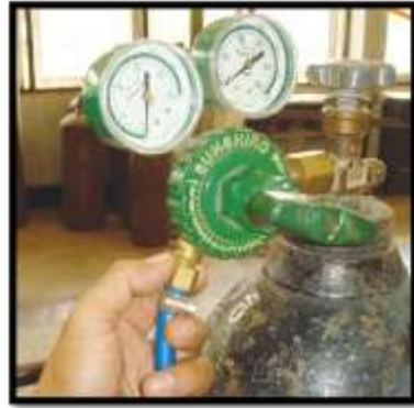
ภาพที่ 3.24 แสดงการประกอบข้อต่อสาย เชื่อมเข้ากับมาตรวัดความดัน
