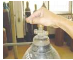
ภาพที่ 3.40 แสดงการถอดฝาครอบหัวท่อ ภาพที่ 3.39 แสดงการนำเปิดวาล์วหัวท่อออกซิเจน
