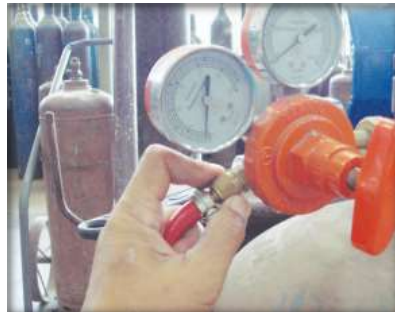
ภาพที่ 3.45 แสดงการติดตั้งมาตรวัดความดันแก๊สเข้ากับท่อแก๊สอะเซทิลีน
